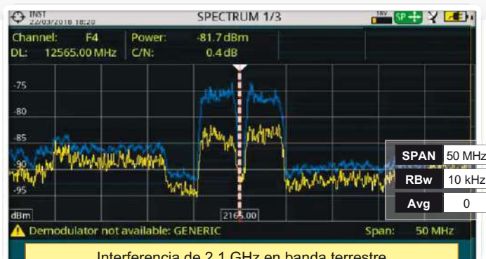
Interferencia de 2,1 GHz en banda terrestre desde una estación de telefonía móvil
