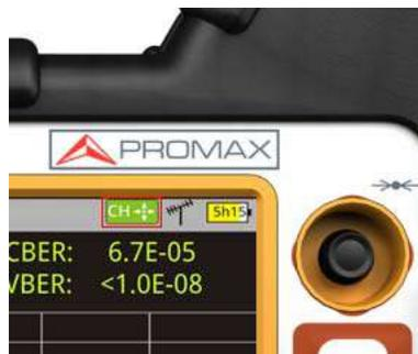
**Figura 40. Joystick con función CH (selección por canal)**
